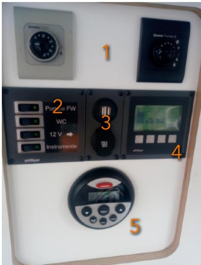
1. Panel: Heizung u. Warmwasserbereitung.
