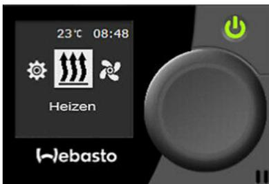
1. Die Anzeige bzw. das Bedienpanel in der Pantry („Webasto“) über die Schnellstarttaste in der obere rechte Ecke einschalten. Die grüne Lampe leuchtet, wenn eingeschaltet,
